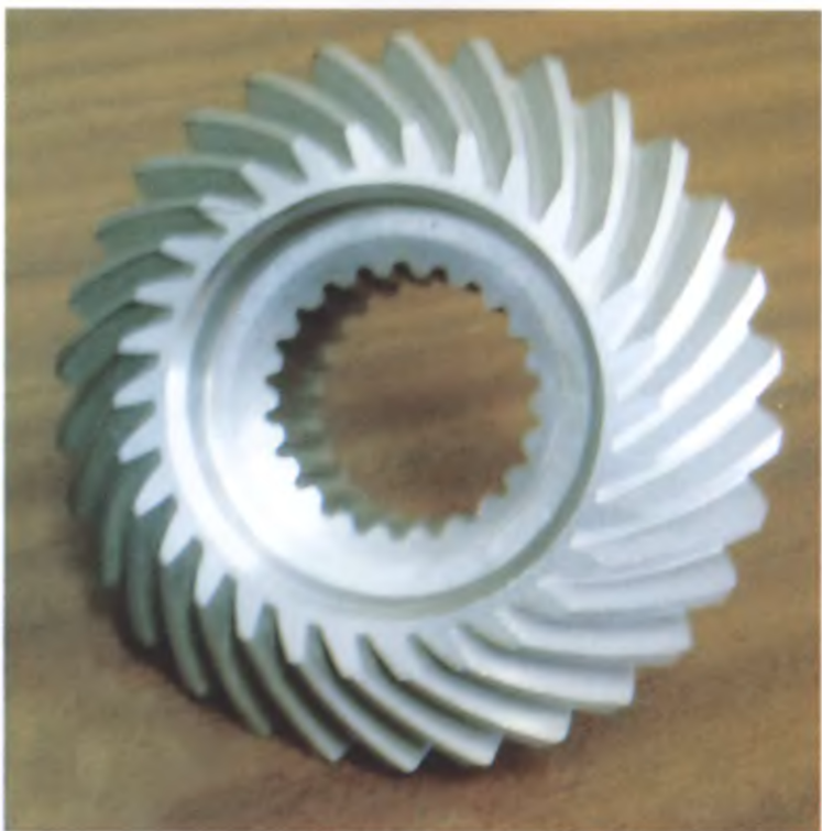
Рис. 3. Зубчатое колесо после ионной цементации
